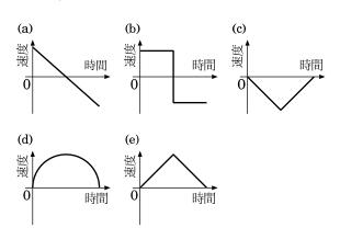
**14.**物体が一次元の単振動  $x(t) = \cos \omega t \ (\omega > 0)$  を行って いる. 次のグラフのうち、時間と速度の関係を最も適切に表 現しているものはどれか. ただし, t=0 をグラフの原点に とっている.
